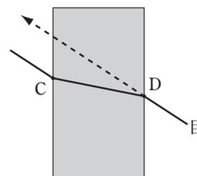
ウ 姉からは、目から点 C に引いた線分の延長線上に弟がいるように見えるので、壁がないときと比べて 下にずれて見える。
