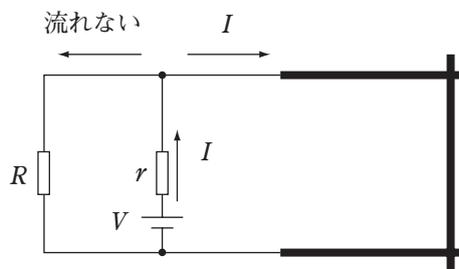
導体棒を流れる電流が磁場から受ける左向きのと同一大きさの力を右向きに加えると、導体棒は静止する。この力の大きさを  $F$  とすると、
