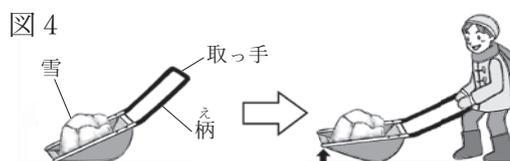
【仮説】 図4の除雪道具の柄を長くすれば、同じ質量の雪を持ち上げるとき、取っ手を押し下げる仕事の大きさは小さくなるのではないか。
