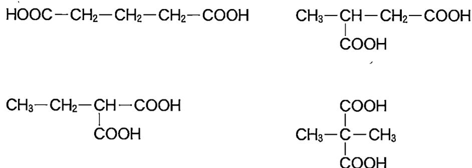
図3 4種類のジカルボン酸  $C_5H_8O_4$  の構造式
