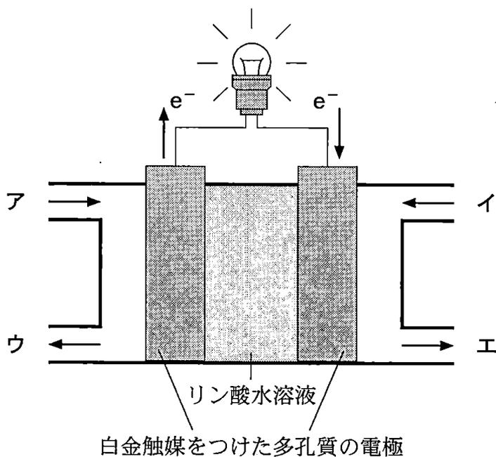
図 1 リン酸型燃料電池の模式図
